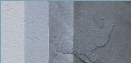
Primer Slurry Texture Color and Seal
